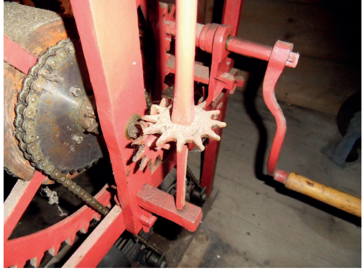
Afb. 5 Haakse overbrenging van de grondas met de verticale uuras die de wijzers aandrijft.
