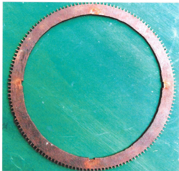
Afb. 20 In de velg van het grondrad ontbreekt een inkeping voor de bevestiging van de spaken.
