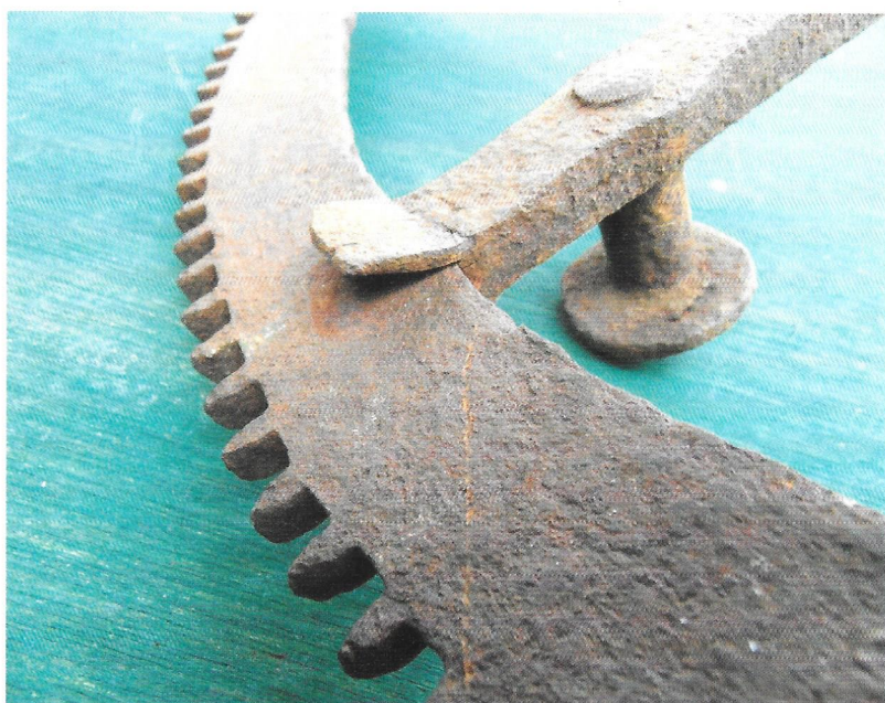
Afb. 22 De spaken zijn aan de velg geklonken.
